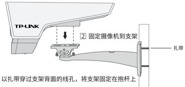
① 以扎带穿过支架背面的线孔，将支架固定在抱杆上
